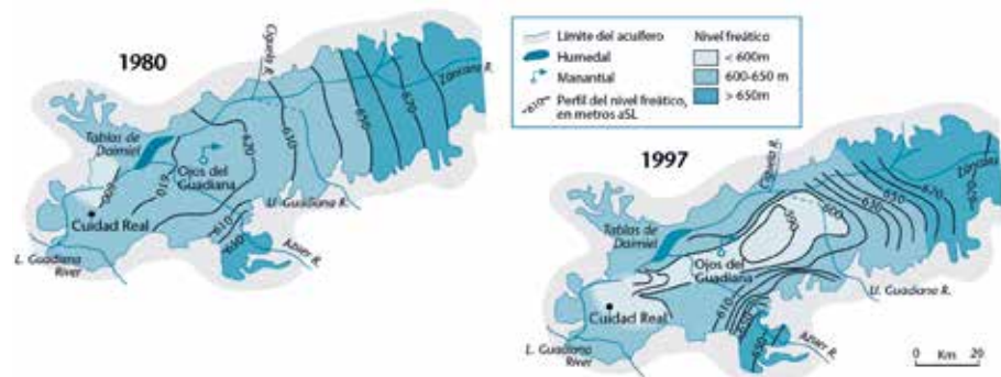
Figura 4. Evolución de niveles piezométricos en las tablas de Daimiel (Custodio, 2002).
