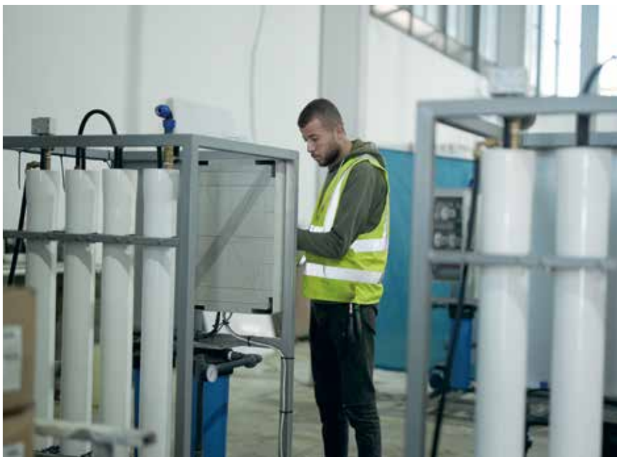
Personas trabajadoras contratadas en Gaza por Oxfam Intermón están fabricando seis unidades de desalinización, que se distribuirán en los lugares que las personas desplazadas internas utilizarán para acceder a agua potable limpia. © Alef Multimedia/Oxfam.
